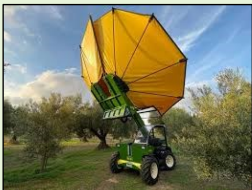
Macchina semovente SICMA B440XL con scuotitore al tronco e ombrello rovescio
